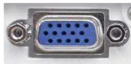
miniD-sub15pin (VGA) 端子
